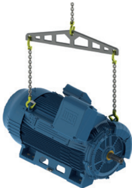
Figura 7 - Içamento com correntes verticais
