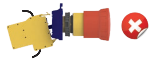
Bloco NÃO montado corretamente na flange.
