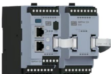
A Unidade de Expansão Digital (EDU) possibilita a ampliação do número de entradas e saídas digitais presentes na Unidade de Controle (UC) do SRW01. A EDU adiciona 6 entradas e 4 saídas, podendo ser utilizada para monitorar sinais e acionar dispositivos externos.
